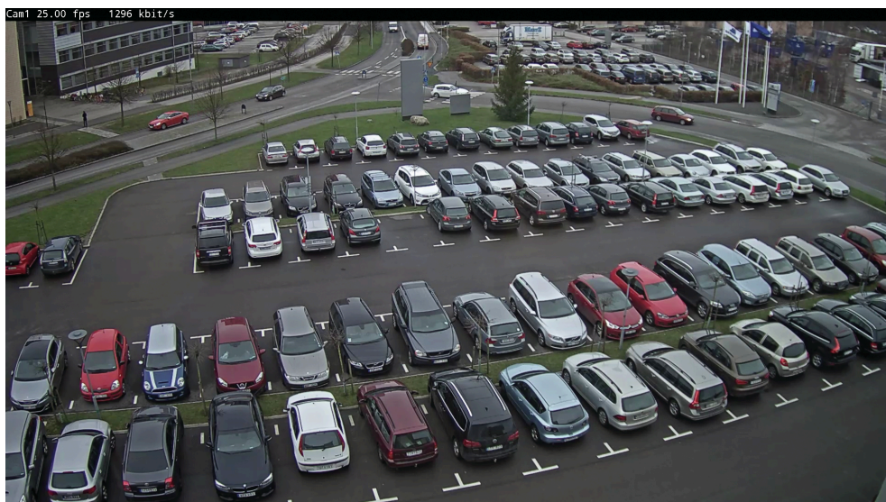
Oben: Tagesszene mit häufigen, aber nur leichten Bewegungen. Bitratenreduzierung insgesamt: 50 %. Zipstream-Stärke: hoch. Dynamic Group of Pictures: ein. Dynamische FPS: aus.
