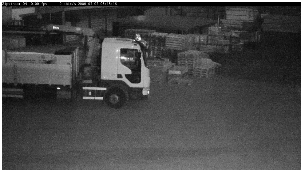
Arriba: escena en modo nocturno con movimiento muy poco frecuente. Reducción total de la velocidad de bits: 99,7 %. Intensidad de Zipstream: extrema. Dynamic GOP: activado. Dynamic FPS: activado.
