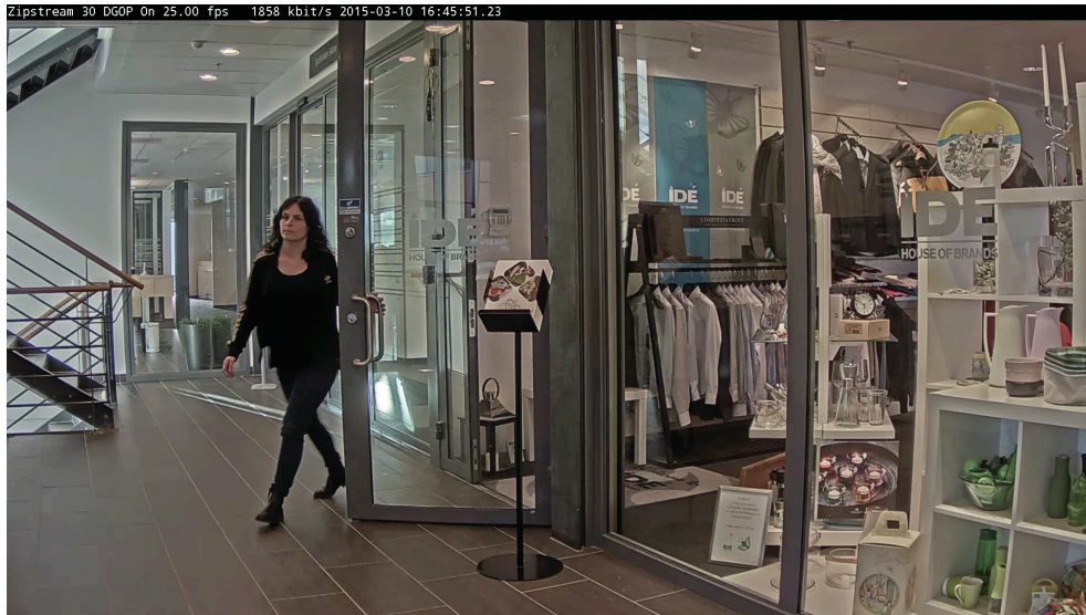
上: 時々動きのある明るいシーン ビットレート総削減率: 25%。 >Zipstream強度: 低。ダイナミックGOP: オフ。ダイナミックFPS: オフ。
