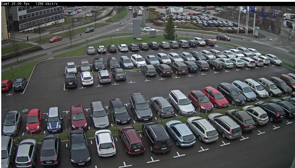
上: 頻繁にわずかな動きが見られる昼間の全体把握シーン。 ビットレート総削減率: 50%。 Zipstream強度: 高。ダイナミックGOP: オンダイナミックFPS: オフ。
