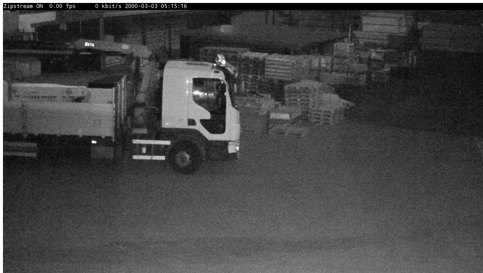
上: 動きがほとんどないナイトモードのシーン。 ビットレート総削減率: 99.7%。 Zipstream強度: 極限。ダイナミックGOP: オンダイナミックFPS: オン。
