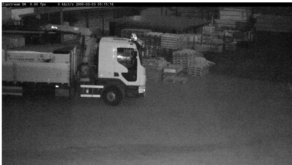
Acima: cena no modo noturno com movimento muito esporádico. Redução total da taxa de bits: 99,7%. Potência do Zipstream: extrema. Grupo de imagens dinâmico: ligado. FPS dinâmico: ligado.
