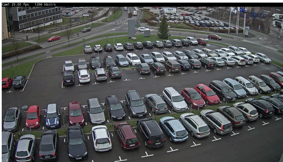
上图：日间全景画面，存在频繁小幅运动。 整体比特率降幅：50%。 Zipstream 压缩强度：高。动态图片组：开启。动态帧率：关闭。
