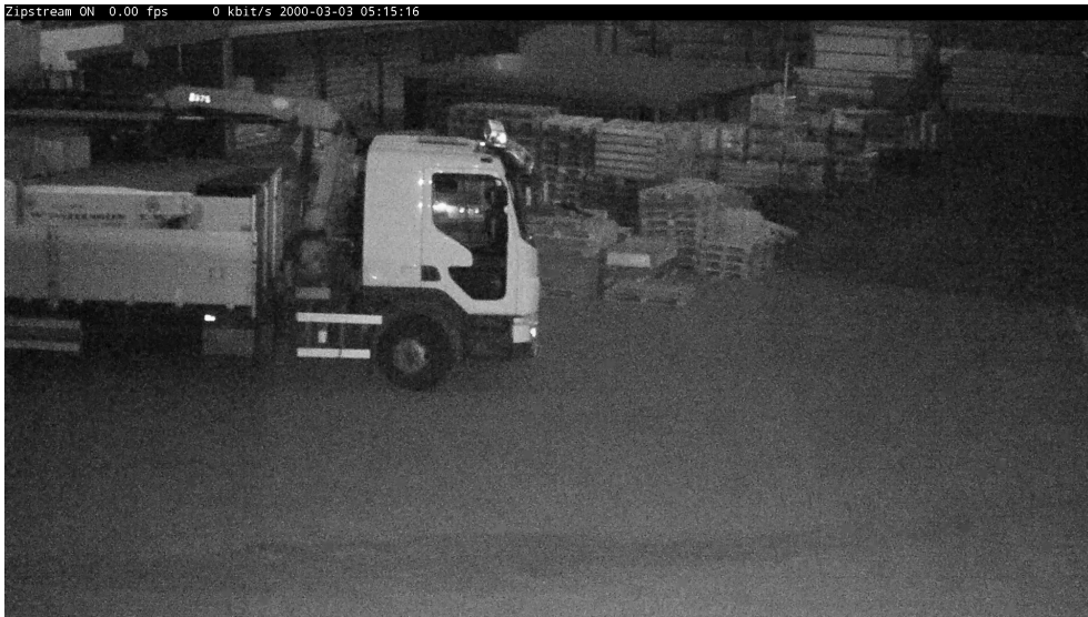
上图：夜视模式画面，极少出现运动。 整体比特率降幅：99.7%。 Zipstream 压缩强度：极高。动态图片组：开启。动态帧率：开启。
