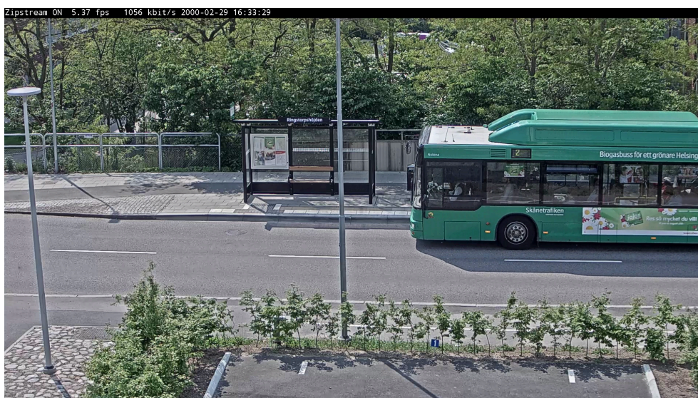
上图：日间画面，偶有明显运动。 整体比特率降幅：73%。 Zipstream 压缩强度：极高。动态图片组：开启。动态帧率：开启。
